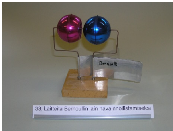
Kuva 4. Laite Bernoullin lain esittämiseksi, ylimmäinen osa valmistettu pallon muotoisista joulukoristeista, joista toisella on kovera ja toisella kupera pinta.
