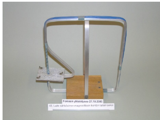
Kuva 33 Alumiinikiskosta valmistettuun kehykseen kierretty käämi ja meltorautapuikot helpottavat sähkövirran magneettikentän tutkimista.
