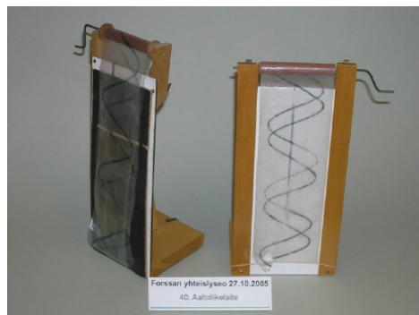
Kuva 27. Aaltoliikelaite, jolla voidaan havainnollistaa aaltonauhan avulla mm. tulo- ja heijastusaallot
